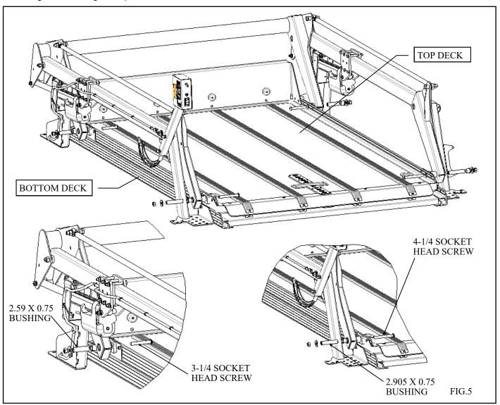
6.18 Positioning the DD2000 assembly:
